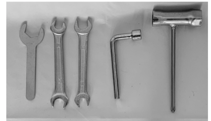
Figura 21. Herramientas manuales incluidas en el juego de herramientas de Mantenimiento y Montaje de silla Liberty.
