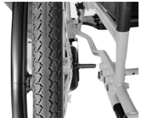
Figura 15. Colocación / extracción del eje de la rueda trasera del manguito del eje
