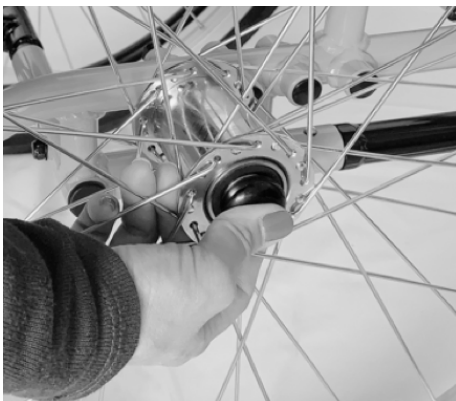
Figura 13. Botón de liberación rápida del eje de la rueda trasera.
